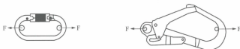
图 C.5 连接器静负荷试验示意图
